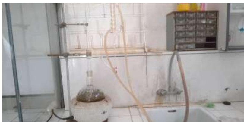
Figure 4 : Dispositif d'hydrodistillation Clevenger.
